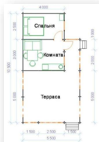
Обвязка, стеновой комплект профилированный брус 45x135 , фундамент блоки, крыша ондулин.
