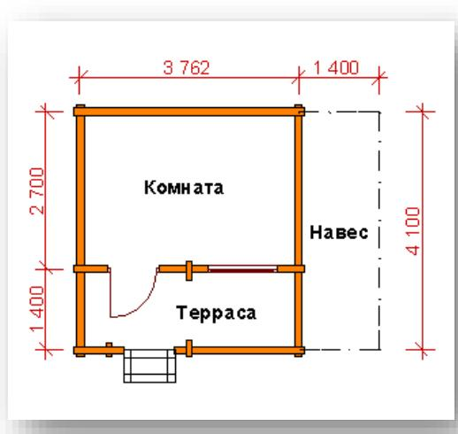
Обвязка, стеновой комплект профилированный брус 45x135 , фундамент блоки, крыша ондулин.
