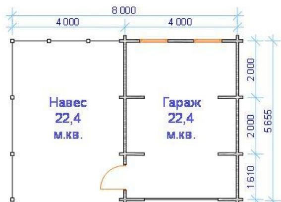
Обвязка, стеновой комплект профилированный брус 45x135 , фундамент блоки, крыша ондулин.
