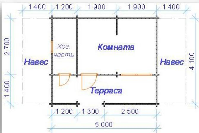
Обвязка, стеновой комплект профилированный брус 45x135 , фундамент блоки, крыша ондулин.
