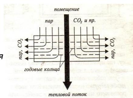
Рис.1. Схема работы деревянного бревна
