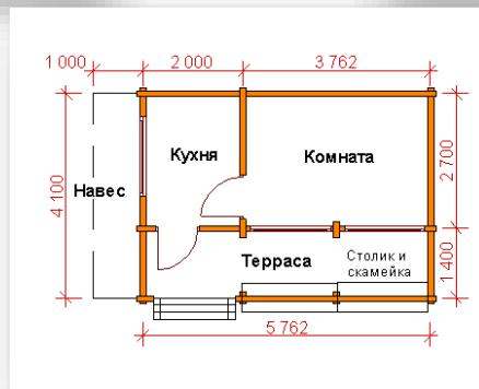
Обвязка, стеновой комплект профилированный брус 45x135 , фундамент блоки, крыша ондулин.
