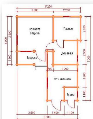
Обвязка, стеновой комплект профилированный брус 45x135 , фундамент блоки, крыша ондулин.
